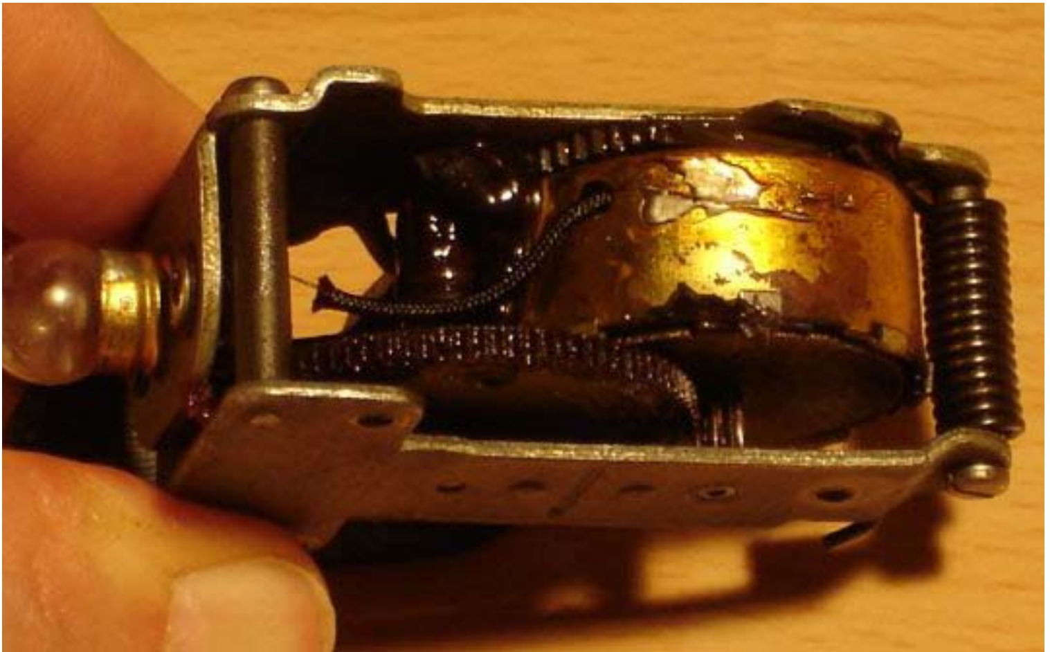
Die Mechanik der Philips Lampe Type 7424 mit viel Fett – für ein langes Leben!
